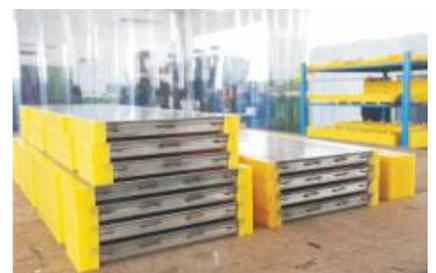
Flache Spaltsiebe aus geschweißtem Profildraht werden auf unseren Flachsweißmaschinen hergestellt, dabei werden profilierte Profildrähte mit Stützprofilen in einem Winkel von 90° verschweißt. Eine präzise Spaltweite wird durch Verwendung modernster Schweißtechnologien erreicht. Als Ergebnis erhält man eine stabile Siebkonstruktion mit der Fähigkeit, hohe Belastungen aufnehmen zu können.
